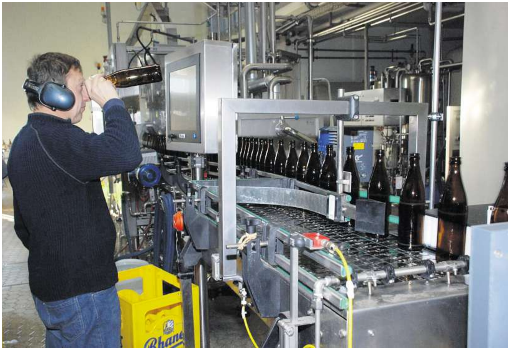
Am Ende einer ausgeklügelten computergestützten Prüfung entscheidet das Auge des Brauerei-Mitarbeiters über die leere Flasche.
